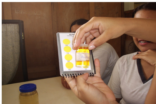
Fig. 12. Averiguação da presença ou não de oxigênio dissolvido nas águas e quantidade de cloro.
